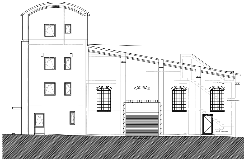
Ansicht Süd Niederdruckkesselhaus
